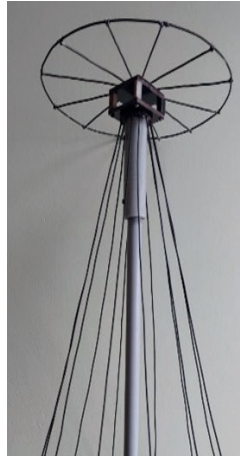
Рисунок 2 – Итоговая конструкция дискоконусной антенны
